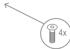
Legen Sie die Standsäule auf eine Unterlage um Beschädigungen zu vermeiden. Verschrauben Sie die Bodenplatte mit der Standsäule, verwenden Sie hierfür die M8X40 Senkkopfschrauben.
