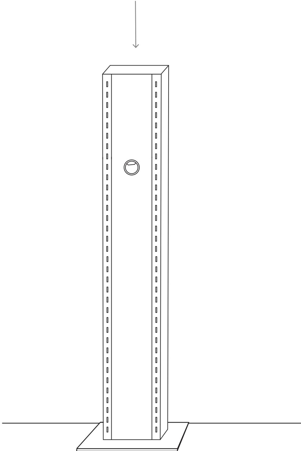
Verlegen Sie danach innerhalb der Säule alle benötigten Kabel und schieben Sie anschließend die Frontblende vorsichtig von oben in die Säule ein. Vermeiden Sie es die Blende zu verkanten um Beschädigungen zu vermeiden.
